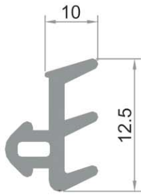
19-20mm cam contası Glass Joint for 19-20 mm 19-20 мм уплотнитель стекла جوان للزجاج ١٩-٢٠مم
